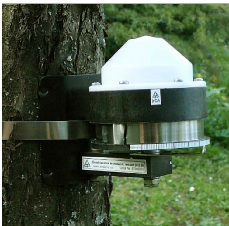
Obr. č. 15 – Ukázka zapojení elektronického dendrometru (ZDROJ: KUČERA 2007)
